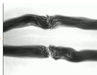
電源コードに断線が発生
