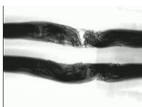
電源コードに断線が発生
